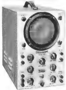
12,5-cm-Bildröhre mit Flutlichtstrahlerscheibe und kontinuierlicher Helligkeitsregelung, Strahlverschiebung horizontal und vertikal, Rücklaufaustastung, Helligkeitsmodulationsanschluß, Eichspannung, 50 Hz und Sägezahnabgang. Technische Daten: Vertikal: Gleichspannungs-Gegentaktverstärker 0-5 MHz (verwendbar bis 10 MHz) 10 mV/cm, 4fach frequenzkomp.
