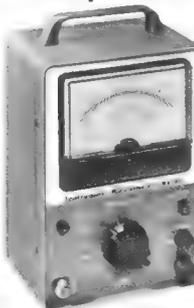
Es wurde für die Messung von Nf-Spannungen zwischen 10 mV und 300 V konstruiert und umfaßt frequenzmäßig den Bereich von den niedrigsten Tonfrequenzen 10 Hz bis 800 kHz. Der kleinste Ableswert ist 0,2 mV im 10 mV-Bereich. Der Breitbandverstärker benutzt die Kaskodenschaltung, die niedriges Eigengeräusch und stabile Arbeitsweise sicherstellt. Die Skala des Meßinstrumentes enthält eine zusätzliche dB-Eichung, wobei 0 dB = 1 Veff als Bezugspegel benutzt ist.
