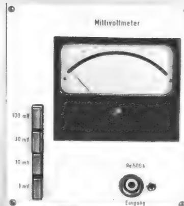
Bild 1. Gesamtansicht des Millivoltmeters. Der Tastenzustand kann beliebig gewählt werden, da man nur vier Kontakte benötigt
