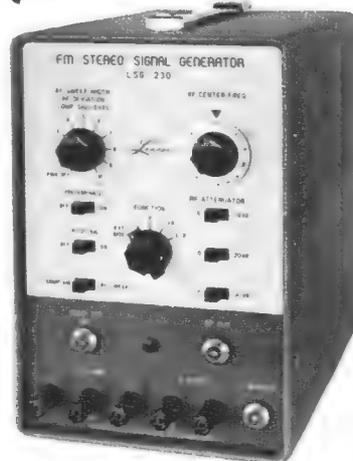
Dieses Gerät ist besonders zum Testen und für den Service an Stereo-FM-Rundfunkempfängern bestimmt. Es erzeugt den Hf-Träger, Zwischenfrequenz- und Hf-Marken, 1-kHz-Tonfrequenz und zusammengesetzte Signale.
